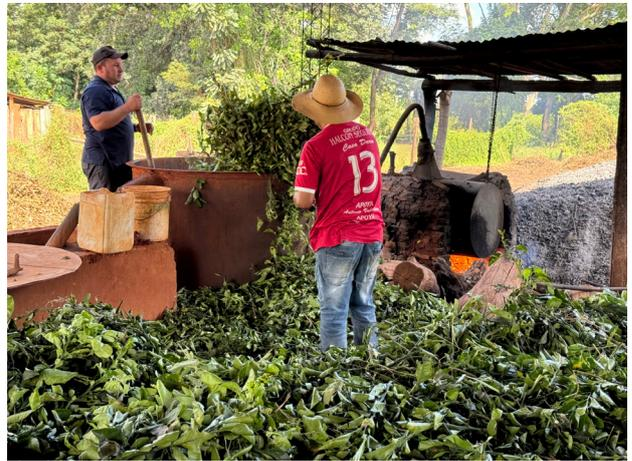
Foto 17. Alambique continuo, de tres pipones, para la extracción de petitgrain
